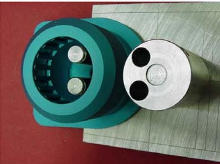
*Das neue Teleskop: Die präzise Führung erfolgt durch zwei innenliegende, präzisionsgeschliffene Passstifte, die Feststellung durch eine selbstzentrierende Spannzange.*
